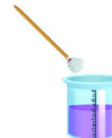
**Figura 2.6** Acerca la torunda humedecida con el extracto hacia el vaso, lentamente y sin tocar los bordes.
