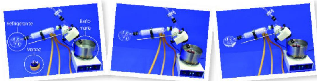
**Figura 1.29** La destilación se utiliza cuando se tienen dos líquidos que se mezclan homogéneamente y tienen diferente punto de ebullición.
