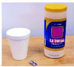
**Figura 4.29** ¿Qué le ocurre al plástico y a la hoja de acero del sacapuntas dentro de un vaso con agua y sal?
