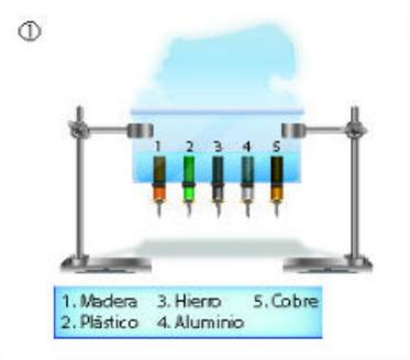
**Figura 2.24** Clavos acoplados a barras de diferentes materiales a los que el agua caliente les transfiere calor.
